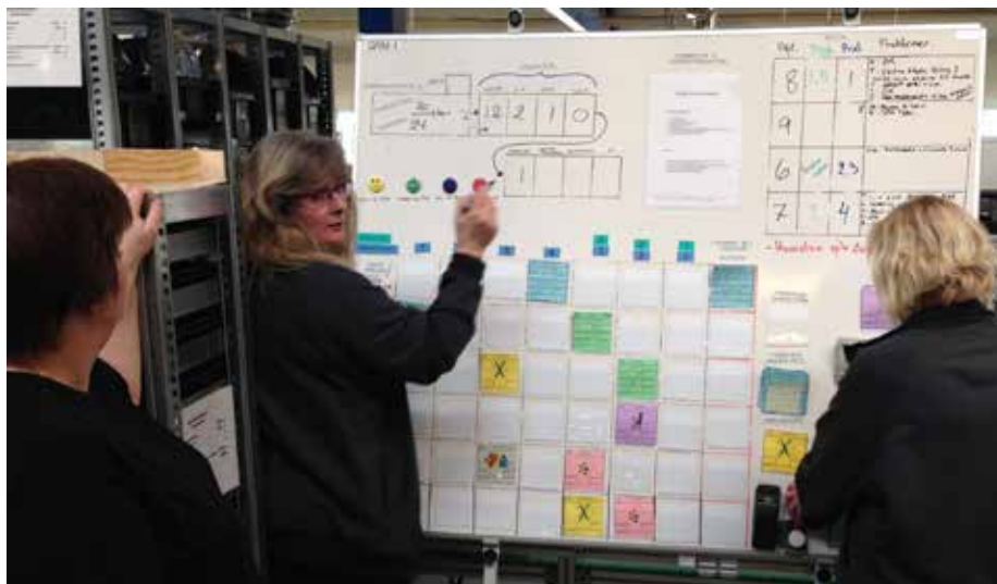
Billede 1: Dagens arbejde planlægges og fordeles mellem medarbejderne i cellen, og den daglige udnyttelsesgrad beregnes og visualiseres på en intuitiv måde. Sedlerne er farvekodede, hvor grøn repræsenterer prototypeproduktion, og blå standard lav-volumen produktion. Lyserød er vedligeholdelse, brun krydstræning og gul løbende forbedringer, hvilke behandles præcis som var de produktionsordrer.
